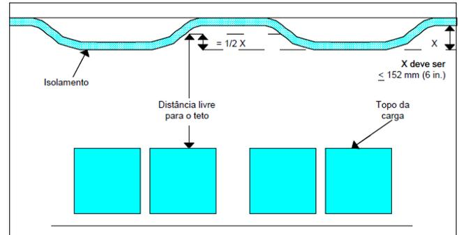
Figura E.5: Forro com isolamento que desvia ou enverga para baixo da estrutura do teto no teto (caso 1)
