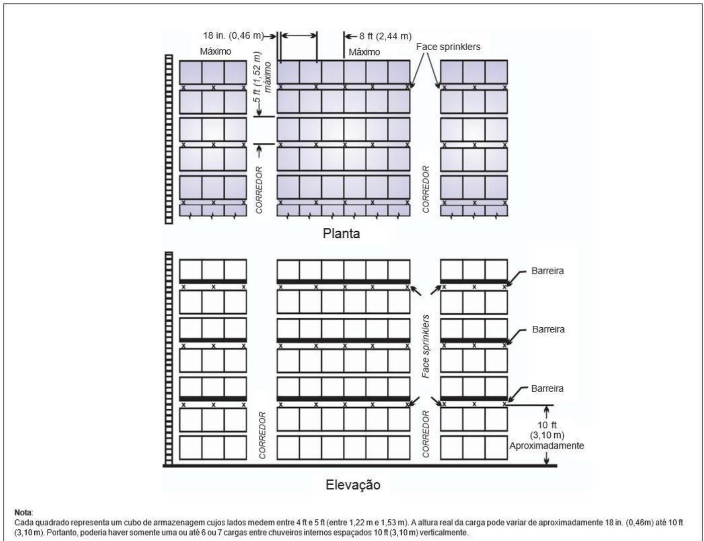
**Figura 5.3.5.4.1.3(d):** Distribuição de chuveiros internos, plásticos em caixas de papelão e plásticos não expandidos expostos, estruturas portapaletes múltiplas, altura de armazenagem acima de 7,6 m (25 ft) – **Opção 2** [(Espaçamento máximo de 1,5 m (5 ft))]
