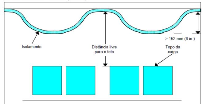
Figura E.6: Forro com isolamento que desvia ou enverga para baixo da estrutura do teto no teto (caso 2)
