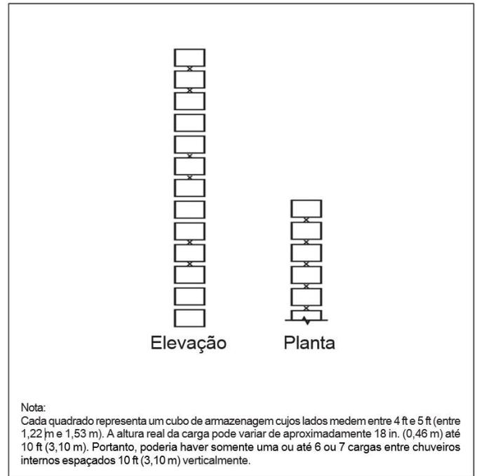
**Figura 5.3.4.4.1.2(b):** Distribuição de chuveiros internos, mercadorias Classe I, Classe II ou Classe III, estruturas porta-paletes simples, altura de armazenagem acima de 7,6 m (25 ft) – **Opção 1.**
