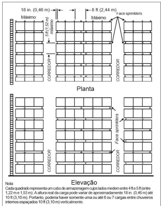
**Figura 5.3.5.4.1.3(f):** Distribuição de chuveiros internos, plásticos em caixas de papelão e plásticos não expandidos expostos, estruturas porta-paletes múltiplas, altura de armazenagem acima de 7,6 m (25 ft) – **Opção 4** [(Espaçamento máximo de 1,5 m (5 ft))]
