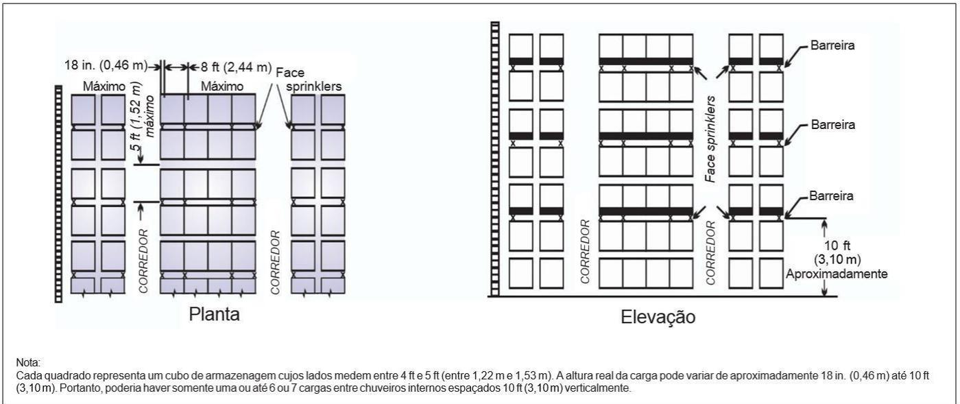
**Figura 5.3.5.4.1.3(c):** Distribuição de chuveiros internos, plásticos em caixas de papelão e plásticos não expandidos expostos, estruturas portapaletes múltiplas, altura de armazenagem acima de 7,6 m (25 ft) – **Opção 1** (Espaçamento máximo de 152,40 cm)
