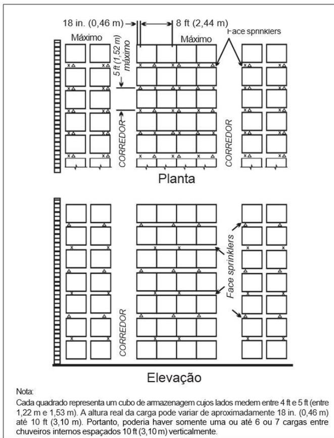
**Figura 5.3.5.4.1.3(e):** Distribuição de chuveiros internos, plásticos em caixas de papelão e plásticos não expandidos expostos, estruturas porta-paletes múltiplas, altura de armazenagem acima de 7,6 m (25 ft) – **Opção 3** [(Espaçamento máximo de 1,5 m (5 ft))]
