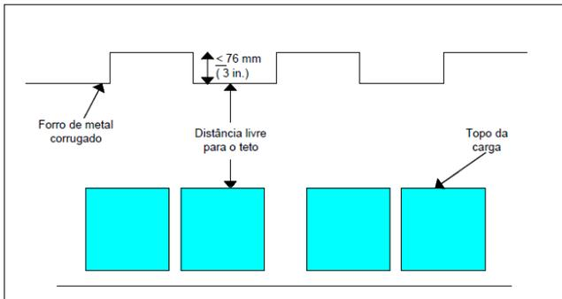
Figura E.2: Forro de metal corrugado com profundidade  $\leq 76$  mm
