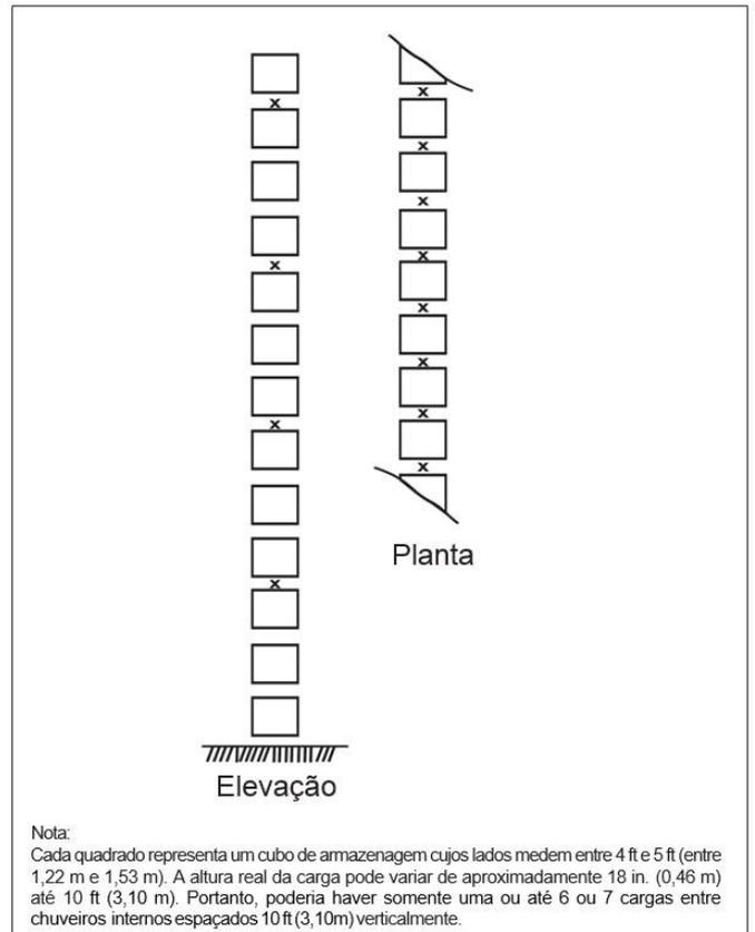
**Figura 5.3.5.1.2.1(b):** Distribuição de chuveiros internos, plásticos grupo A, estruturas porta-paletes simples, altura de armazenagem acima de 7,6 m (25 ft) – **Opção 2.**
