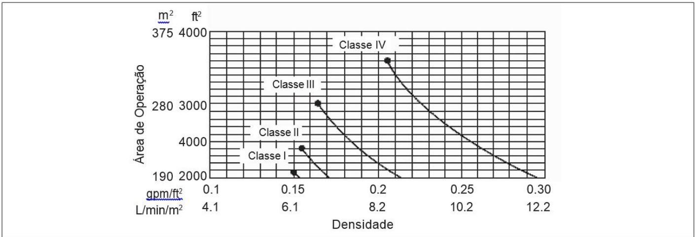
**Figura 5.2.2.1.5.2:** Curvas de projetos de sistemas de chuveiros, armazenagem a 6,1 m (20 ft) de altura – chuveiros de temperatura alta.
