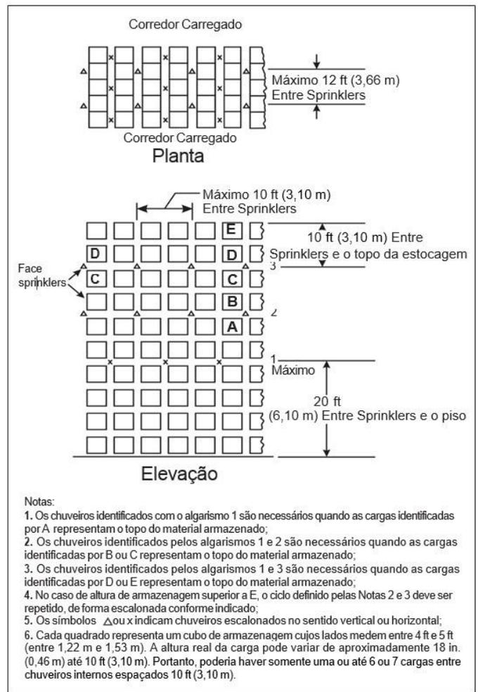
**Figura 5.3.4.4.1.2(e):** Distribuição de chuveiros internos, mercadorias Classe I, Classe II, Classe III ou Classe IV, estruturas porta-paletes simples, altura de armazenagem acima de 7,6 m (25 ft) – **Opção 3.**
