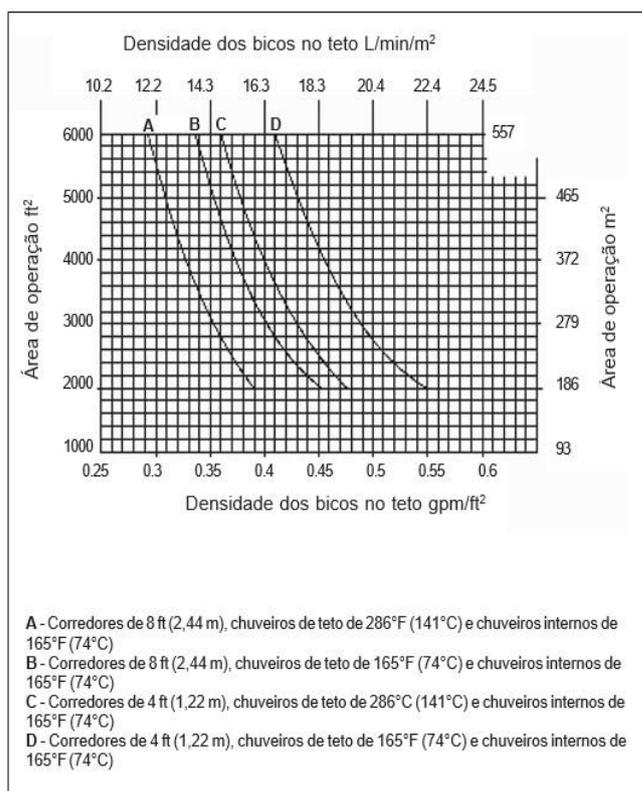
**Figura 5.3.2.1.2(g):** Estruturas porta-paletes simples ou duplas- Armazenagem a 6,1 m (20 ft) de altura em estruturas porta-paletes- Curvas de projeto de sistemas de chuveiros – Mercadoria Classe IV encapsulada – Paletes convencionais.
